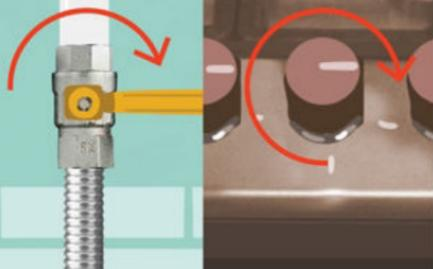
Закройте вентили на газопроводах и краны на приборах
